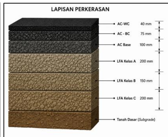
Gambar 4. Nota Desain Alternatif 2 : Tebal Struktur Perkerasan Tipe Granular Roadbase-Struktural Surface dengan CESA 5 Menurut MDPJ 2024. Tebal Total = 765 mm
