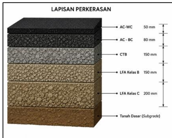
Gambar 3. Nota Desain Alternatif 1 : Tebal Struktur Perkerasan Tipe CTB-Struktural Surface dengan CESA 5 Menurut MDPJ 2024. Tebal Total = 630 mm
