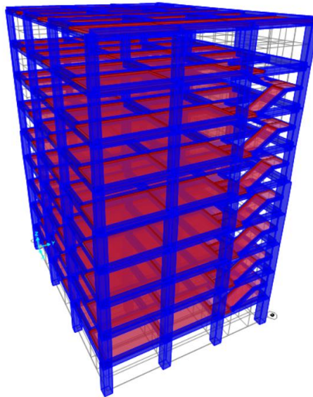
Gambar 1. Pemodelan 3D Bangunan pada SAP2000
