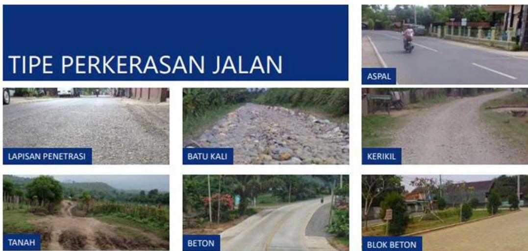
Gambar 3. Tipe Perkerasan Jalan
