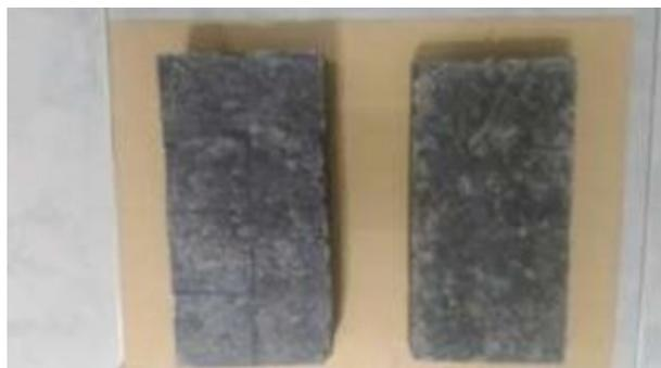
**Gambar 3.** Hasil Cetak Paving Blok Plastik
