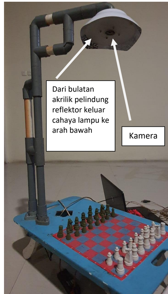
Gambar 2. Posisi kamera dan tambahan penerangan untuk mendapatkan raw image yang konsisten.
