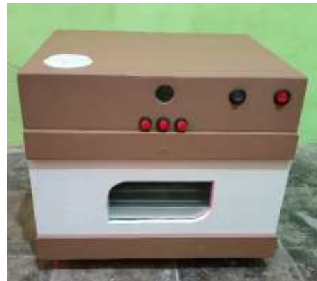
Gambar 6. Alat penetas telur iterasi kedua
