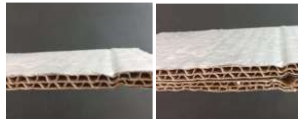
Gbr. 6. Panel insulasi radiatif yang diaplikasikan.
