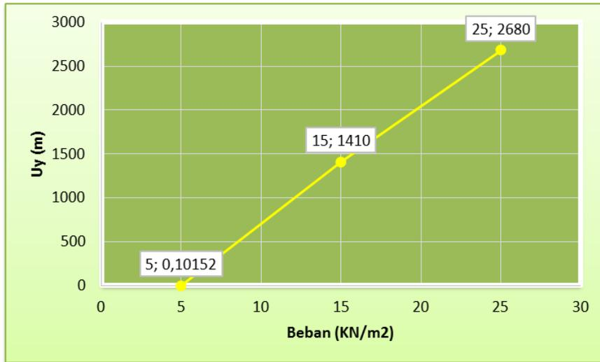
Gambar 8. Grafik Hubungan antara Beban dan Penurunan Tanah
