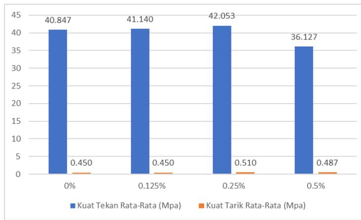
**Gambar 4.** Diagram Hubungan antara Kuat Tekan dan Kuat Tarik Lentur Mortar Serat Ukuran 1x5 mm
