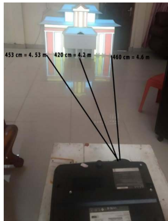
Gambar 7. Ukuran jarak LCD ke maket
